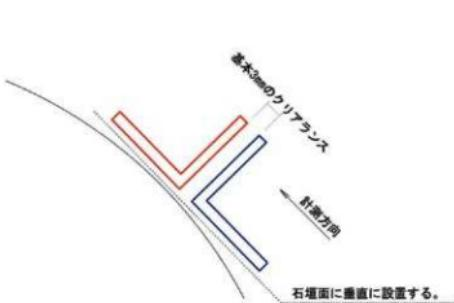
図4-1-5 ゲージIII型の設置
