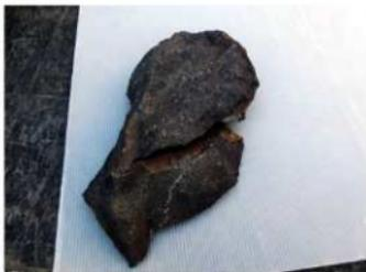
写真5－2－15 除去後の剥離石材片
