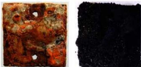
図 5-2-4 鷹島海底遺跡において異なる埋め戻し環境下に設置した鉄板試料（左：土壌のみでの埋め戻し、右：土壌、砂質土、ガス不透過性シートによる埋め戻し）
