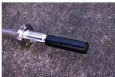
図 3-6-31 トランスポンダー（水中音響測位装置）
