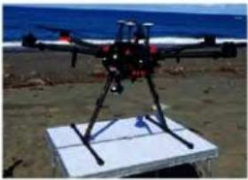
図 3-6-18 ドローン搭載型グリーンレーザースキャナ（上ノ国漁港遺跡）
