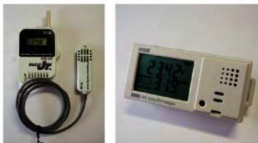
図 5-4-2 ワイヤレス式の温湿度データロガーの一例
