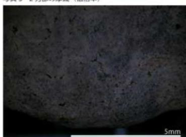
写真5 3刃部の摩滅（低倍率）
