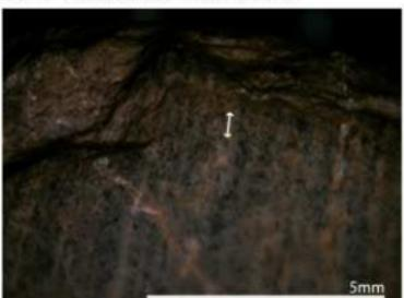
写真12 6刃部の摩滅 (低倍率)
