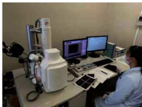
第 525 図 日立製 SU3500 による観察・分析風景(令和 2 年度) 機器には特性 X 線の検出器が付属する。これにより、元素スペクトル図を出力し、元素の定性を確認した。顔料種別の判定は Hg 元素の反応の有無で朱か否かを判断した。
