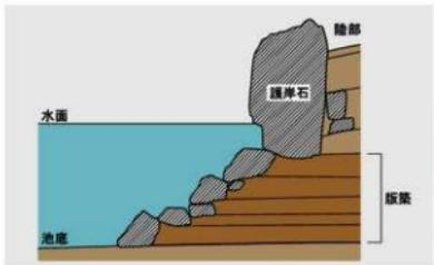
図1 池護岸構造模式図 (1:40)
