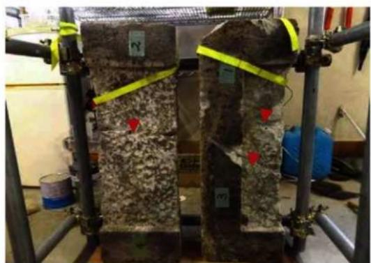
接合部 (▼) 接合部にはステンレスボルトが挿入される
