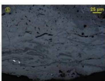
220 図 鉄片・鋸冶滓の顯微鏡組織・EPMA 調査結果
