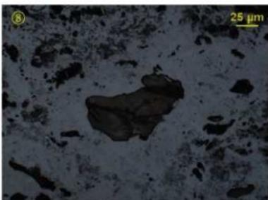
218図 鉄片 鍛冶滓の顕微鏡組織
