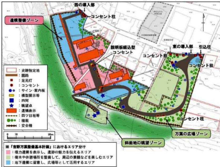
図 33 電気設備配置
