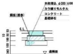
柱埋込平面表示標準断面
