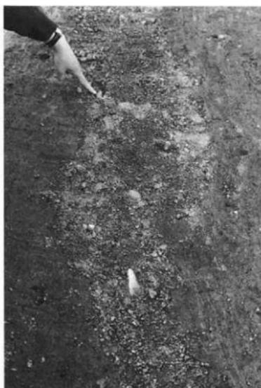
写真6 砂脈を構成する砂礫
