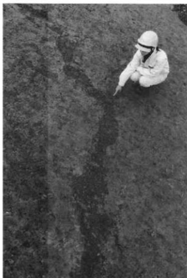
写真5 砂脈の平面形
