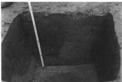
写真48 高まり S06300東側の液状化跡の断面形態
