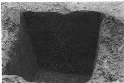
写真46 高まり S 06300西側南部の液状化跡の断面形態
