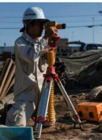
사진2 레벨을 이용한 유구 표고의 기록.
