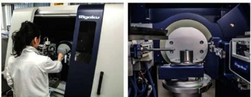
사진11·12 X-ray 회절 분석을 통한 화합물 동정(同定).
