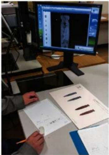
사진⑤ 적외선 기기를 이용해 목간을 관찰하는 모습. 적외선을 반사하는 목재는 흰색으로, 적외선을 흡수하는 억은 검은색으로 보입니다.
