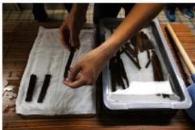
사진⑨ 물갈이 모습. 목간을 보관하고 있는 1,000개 이상의 모든 베트를 확인합니다. 오염이 확인되면 조심스럽게 목간을 꺼낸 뒤 물과 방석을 교체합니다.
