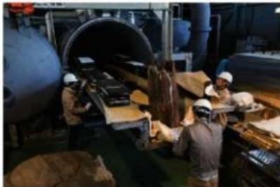
照片1 对木制遗物进行保存处理时使用的大型真空冻干机
