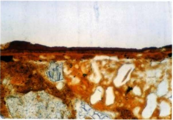
No3. 断面写真下地層、漆層 ( $\times 400$ )
