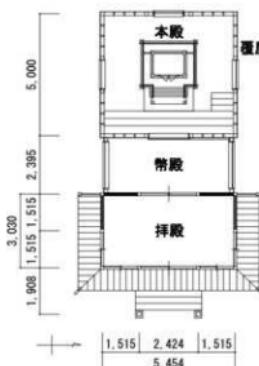
図68-3 平面図(拝殿)
