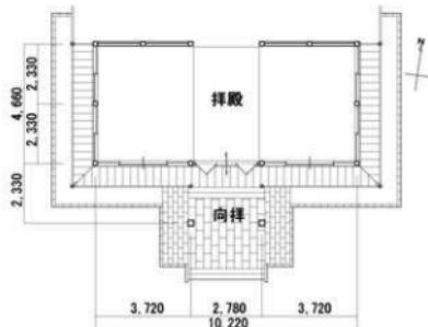
图84-5 平面図(拝殿)
