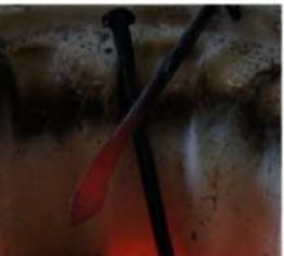
炭火で熱された鉄はおよそ800度です。大人が炭火から鉄釘を取り出し、金床の上で子供がハンマーで打ち付けます。この赤みがある間に親子で息を合わせて叩き延ばしていく
