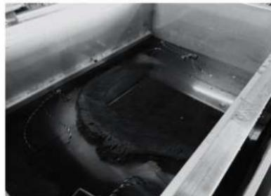
写真4 安定化処理（PEG 含浸作業中）
