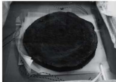
写真3 クリーニング作業（EDTA 浸漬）
