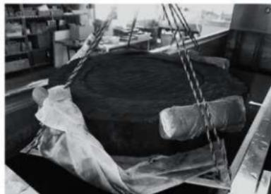
写真5 PEG 含浸槽からの取り出し作業
