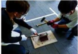
800℃近くまで熱した五寸釘を叩いてペーパーナイフをつくります。「鉄は熱いうちに打て」の言葉どおり、熱しては叩き、熱しては叩きと繰り返し、釘を伸ばして刃を作ります。形づくられた熱い釘は、水に入れて冷やす「焼き入れ」を行うことで強度を高めます。最後に砥石で刃を研ぎ、柄を作って仕上げます。
