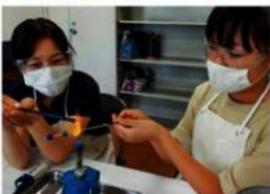
ガスマーナーで溶かしたガラスを鉄芯に巻き付ける技法で小玉やまが玉を作ります。ガラスは単色だけでなく混色したり、別の溶かしたガラスで玉に模様付けしたりすることで、様々なガラス玉を作ることができます。
