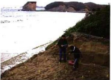
写真4 地中レーダー探査による調査
