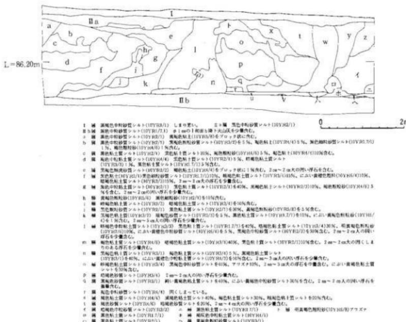
図8 地滑り跡土層断面図
