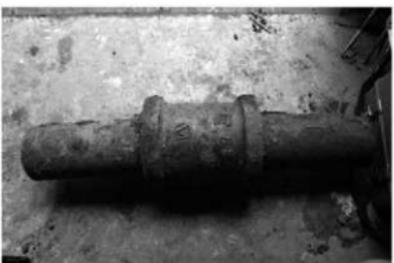
写真35 取り上げた上水管と継輪
