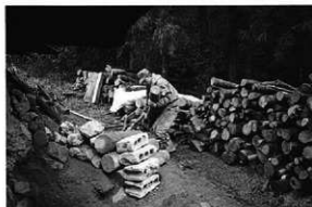
15 神丸、炭材の詰め込み作業
