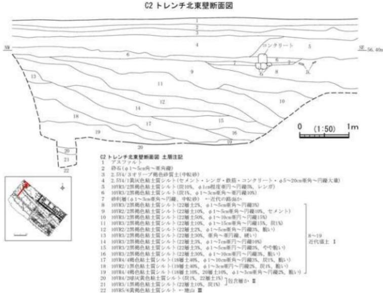
図6 トレンチ壁断面図 (1)
