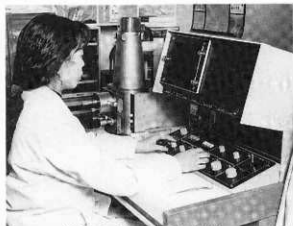
樹種同定 (走査型電子顕微鏡)
