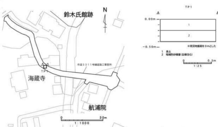
第 12 図 市道 5311 号線道路改良事業地内試掘坑配置図・柱状図
