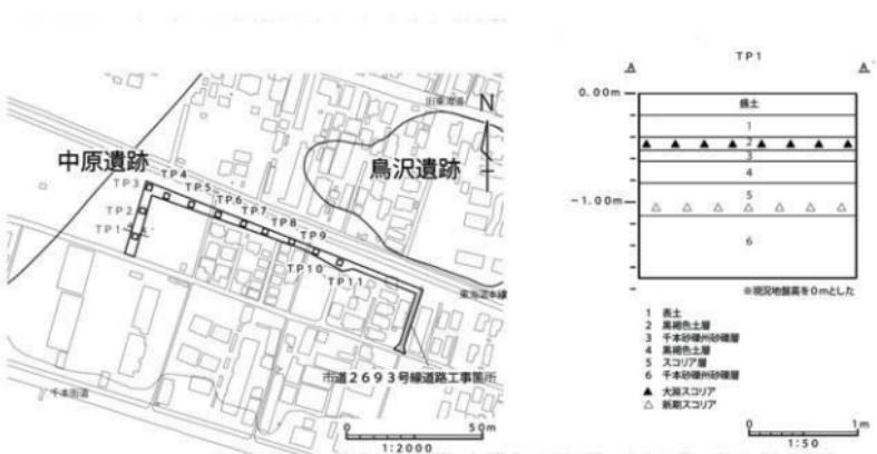
第 16 図 市道 2693 号線道路築造工事地内試掘坑配置図・柱状図
