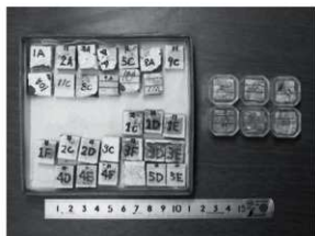
図2 考古地磁気測定用試片 立方体に整形した状態(左)と測定用プラスチックキューブに収めた状態(右)。
