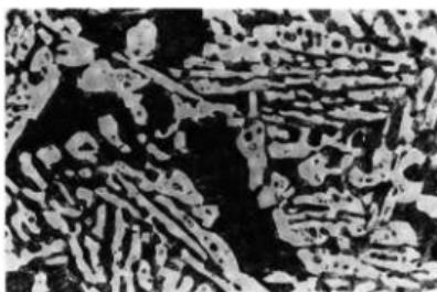
写真5 №10 銅中湯路 ピクリン酸  $(\times 100)$
