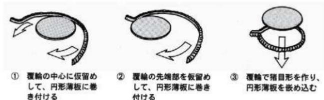
第25図 覆輪の中央に薄板を埋め込む技法3種（依田2001より引用）
