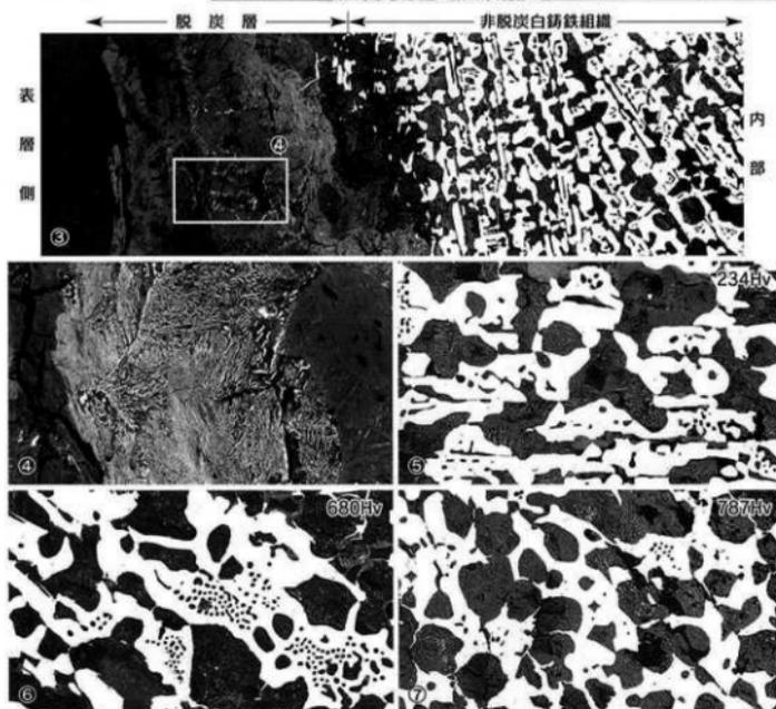
Fig.56 顕微鏡組織写真
