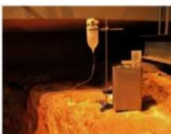
写真36 基質強化試験状況
