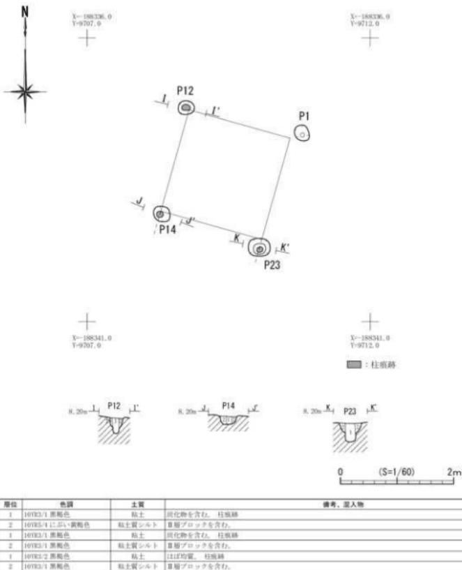
第7図 I区SB1掘立柱建物跡平面・断面図
