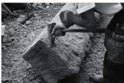
写真9 サシバを使った加工作業
