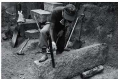
写真7 ツルハシを使った粗削作業(高畠石)
