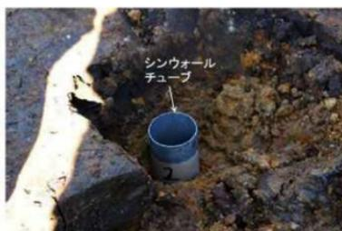
(c) 不攪乱状態の試料2の採取状況
