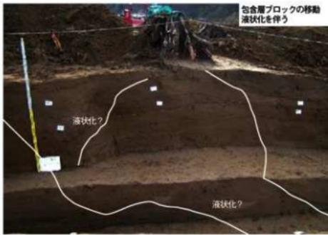
図56 基底部の液状化による地層の変形
