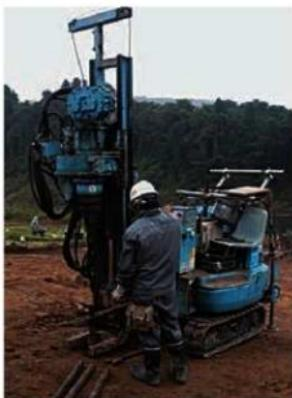
図48 簡易ボーリング機器
