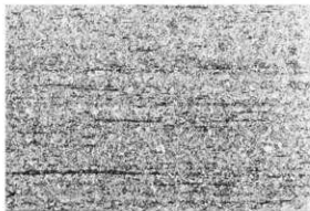
写真 42 資料 No. 5 L断面鉄組織写真×100 (1)
