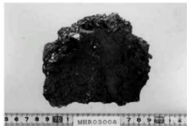
写真15 資料No.8 炉壁（炉下部、羽口付近）1
