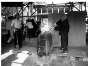
写真8 砂鉄投入のようす
