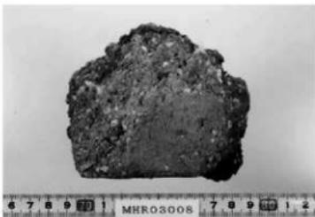
写真16 資料No.8 炉壁（炉下部、羽口付近）2
