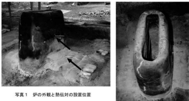
写真 1 炉の外観と熱伝対の設置位置
