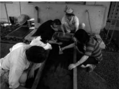
写真4 トイを使った砂鉄選別
