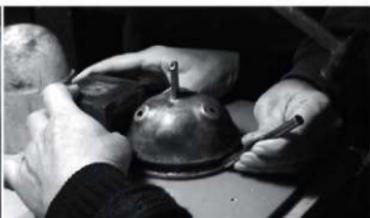
写真 15 ツバ部の接合作業
