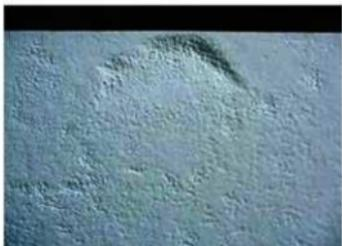
図資 3-7 鉛薬を施し、焼成した陶板
