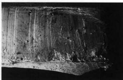
図35 金の切削片の切断面 電子顕微鏡65倍
