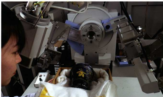
図7 X線回折分析 (Philips 製 X'pert-MPD PW3050)
