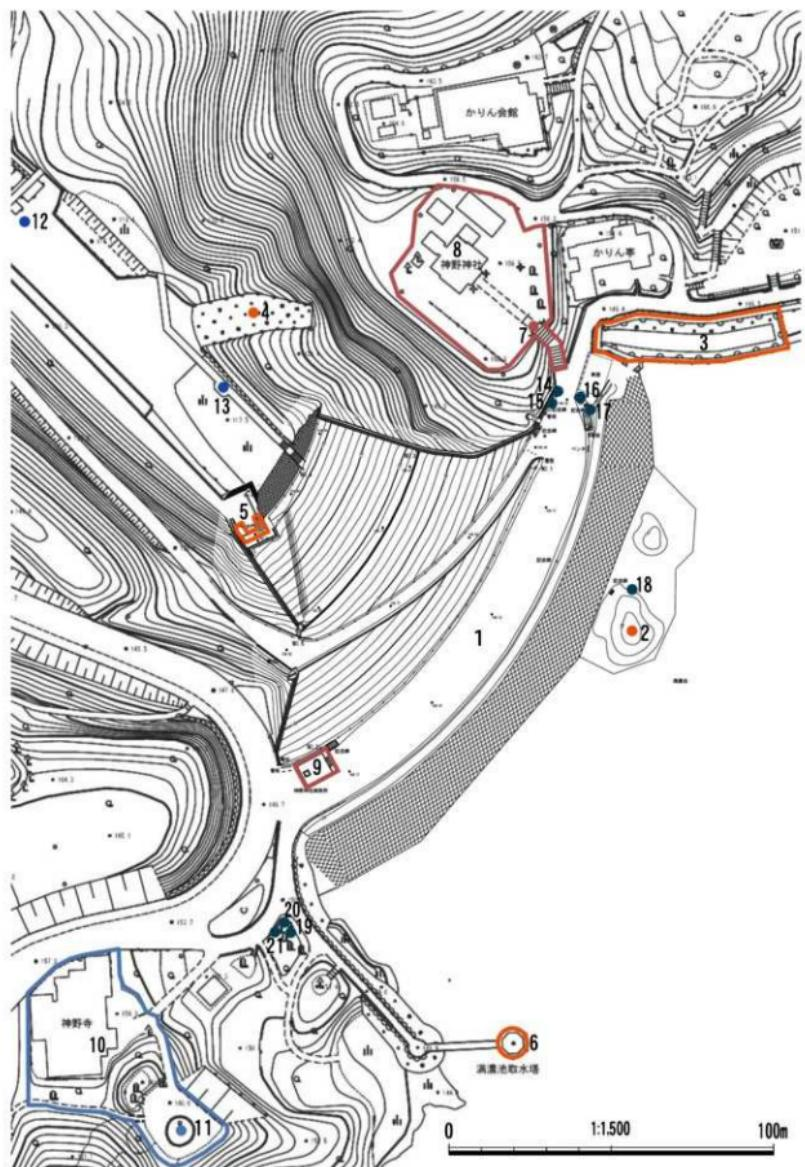
第13図 堤体測量図・周辺構造物位置図
