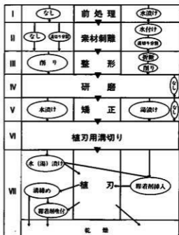
第47図 植刃器製作のフローチャート Fig.47 Flowchart of manufacturing process of a grooved bone shaft
