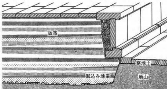
Fig. 9 堀込み地業による基壇模式図
