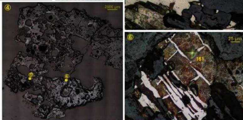
流出滓・ガラス質滓の顕微鏡組織
