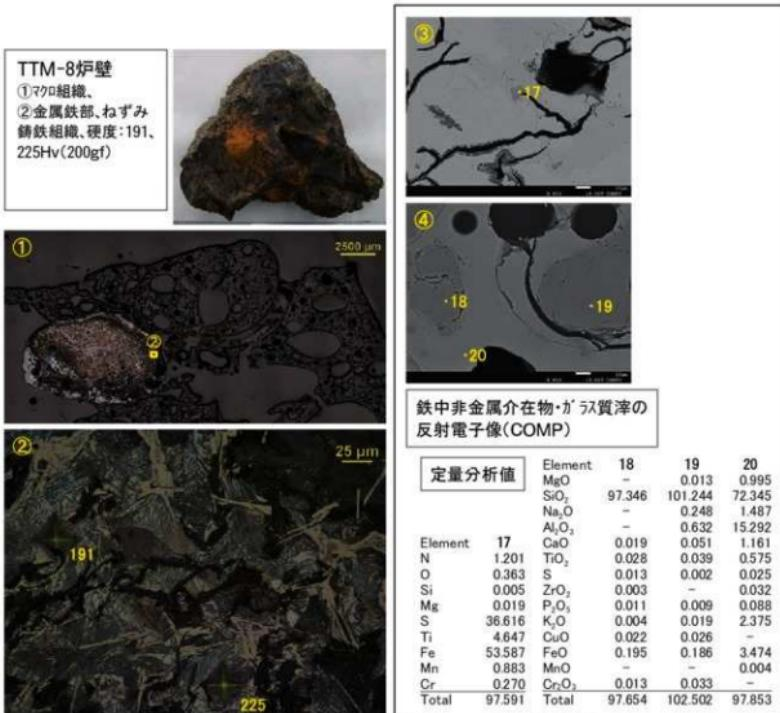
炉壁のX線CT画像・顕微鏡組織・EPMA調査結果
