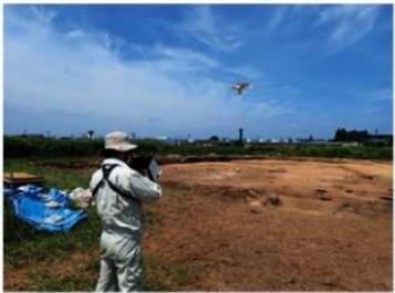
図21 ドローンでの撮影状況
