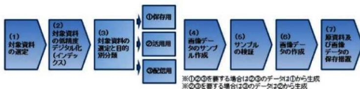
図1 フィルムデジタル化の工程
