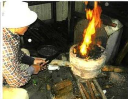
②炉に火をおこし、送風機で風を送りながら火の強さを調節します。中ではヤの材料になる鉄片が熱せられています。
