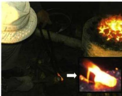
③赤く焼けてやわらかくなった鉄片をヒバサミではさみ、セットウでたたきます。冷えて硬くなってきたら炉に戻し、やわらかくなったら再びたたくことを繰り返し、ヤの形に仕上げます。
