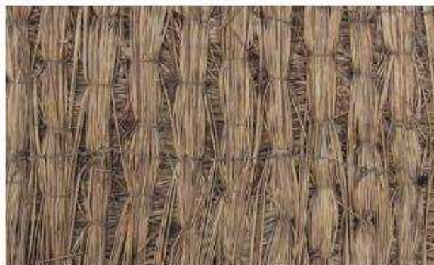
写3-5-42 同上 裏菰 手縫いの畳床で裏菰は筋縫いされる。
