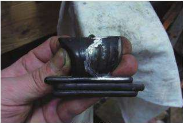
半田接合補修
