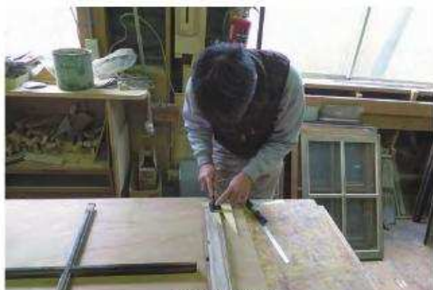
框組み作業状況
