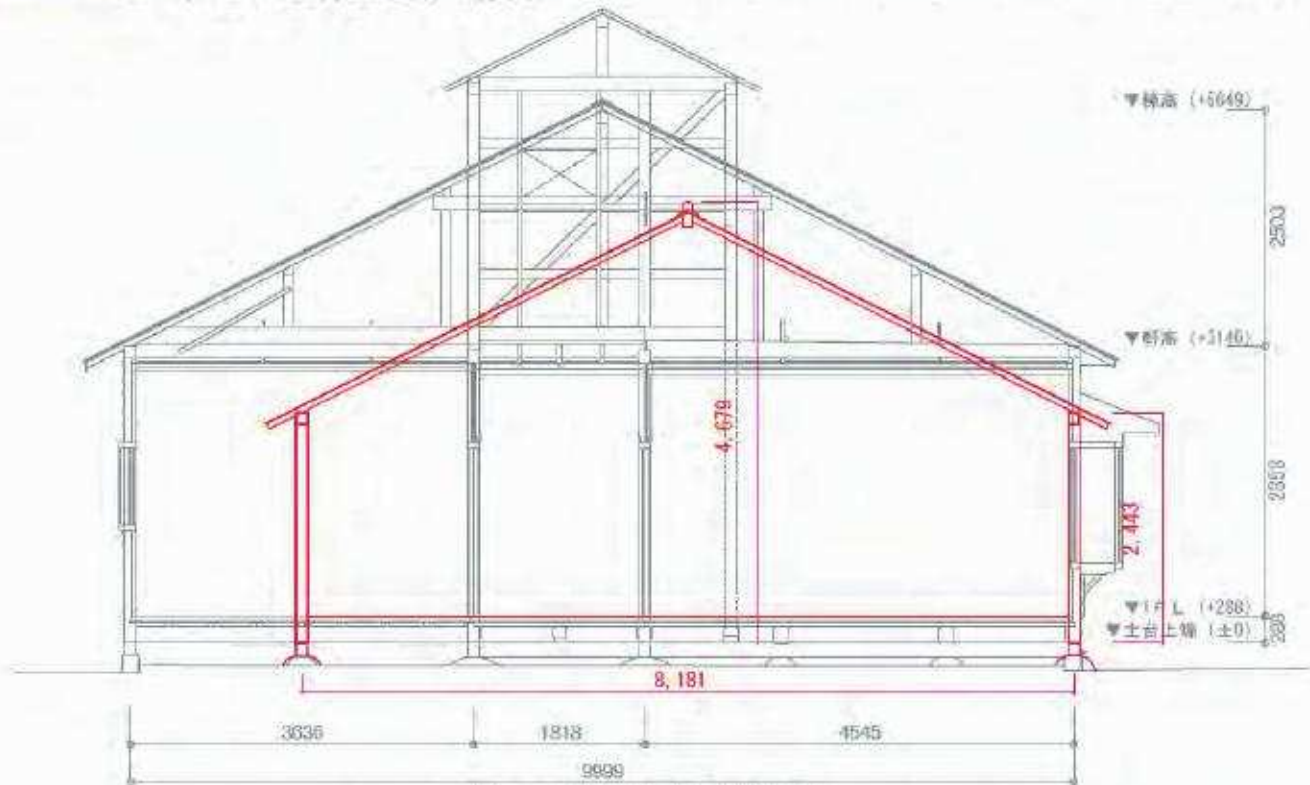
図3-3-4 III期「本家棟」断面想定図 現状より約700mm棟位置が下がる。桁高も低くなるため床や敷地が現状より低かった可能性もある。
