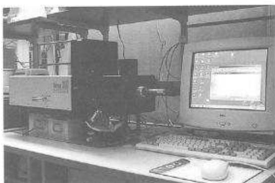
写真1 レーザーラマン分光分析装置
