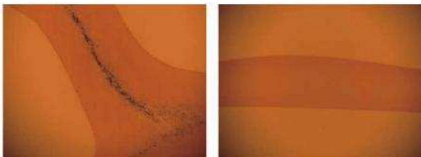
第6図 生漆・クロメ漆の漆膜断面(×50)
