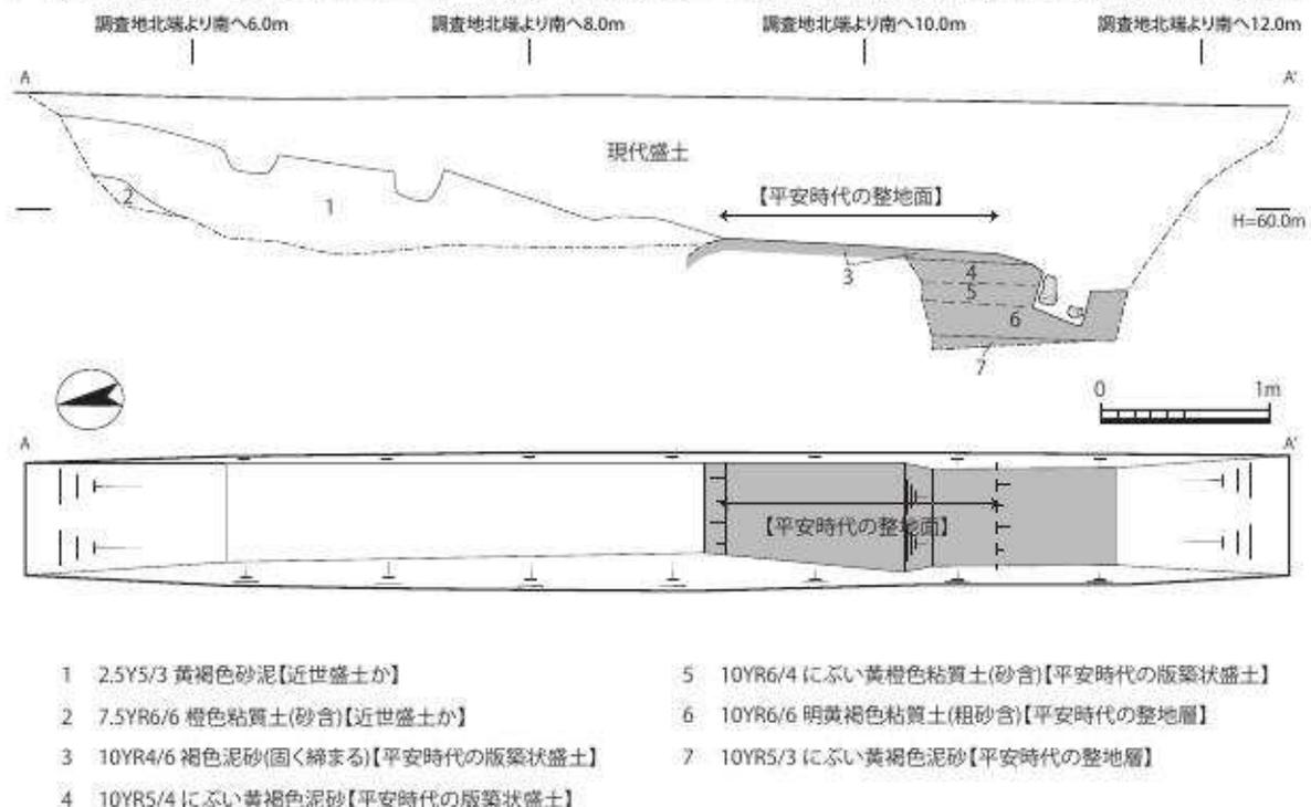
図27 整地層 平・断面図（1：50）
