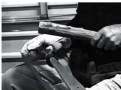
図31 間接打撃装置
