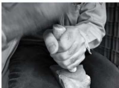
図15 パンチ先端の硬化処理
