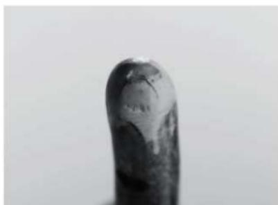
図16 パンチ先端の損傷
